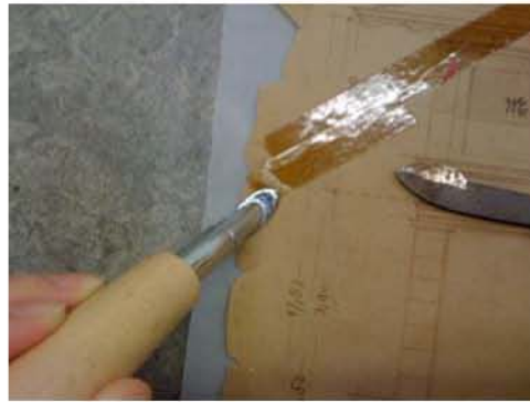
Entfernen des Selbstklebebandes mit Hilfe eines Heizkolbens
