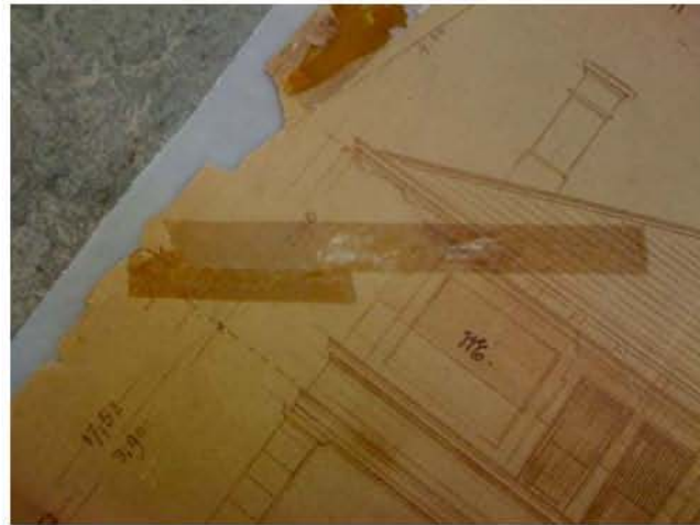
Plan nach der Entfernung des Selbstklebebandes Klebstoff bleibt im Papier zurück und hinterlässt starke Verbräunungen
