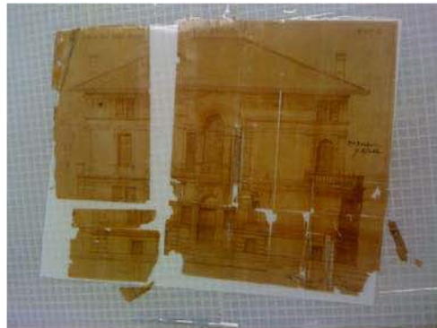
Plan wird auf Wasserfilm ausgerichtet
