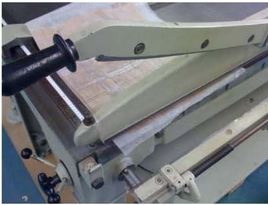
Beschnitt des überstehenden Kaschiermaterials
