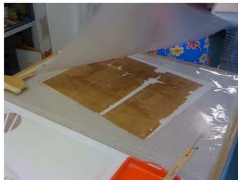
Kaschiermaterial wird mit Hilfe der der Trägerfolie aufgelegt
